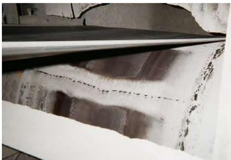
シェルの摩耗により穴があき、ベルトの損傷
